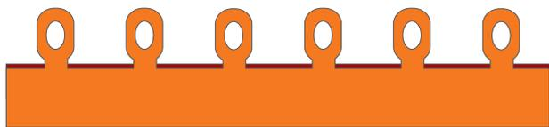
1 Prendere il diametro del tubo e tagliare il collare **DS STOP FIRE MT** con un seghetto da ferro o con un flessibile.
