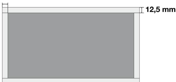
Incastrare come da disegno nel foro muro un perimetro di cartongesso antincendio spesso 12,5 mm nello spessore della parete sp.100 mm, quindi spalmare il perimetro interno con sigillante antincendio **DS STOP FIRE MW**.
