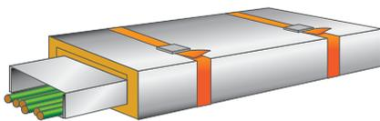
Avvolgere provvisoriamente la coppella in **DS STOP FIRE WRP 2-T** con una coppia di cinghie da carico (solo per grandi passerelle) e fissarla sulla passerella con fili in acciaio Ø 1 mm con un interasse di 50 cm circa tramite nodo a torsione, quindi rimuovere le cinghie.
